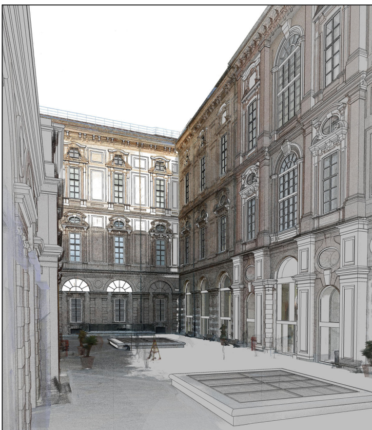
08. Sovrapposizioni tra nuvole di punti e porzioni di modello HBIM
