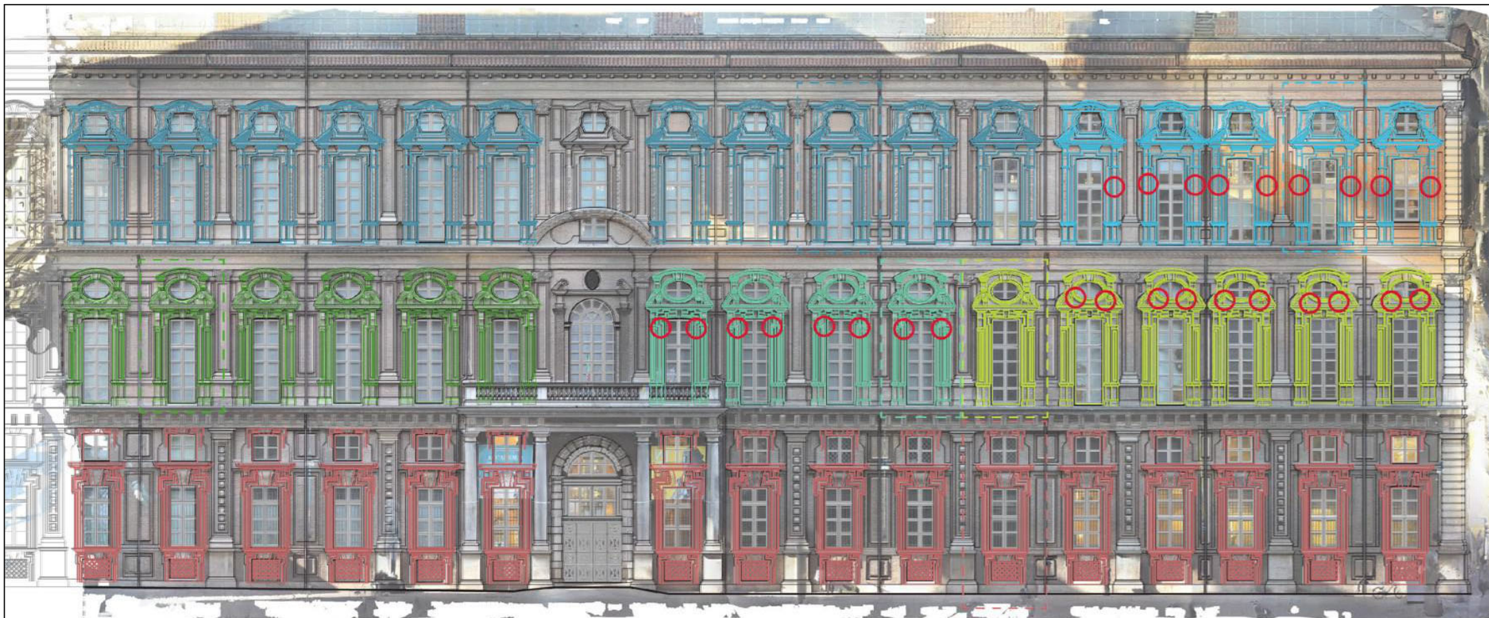
04. Ortofoto del prospetto esterno su Via Accademia: tematizzazione cromatica degli infissi per piani e tipologie
