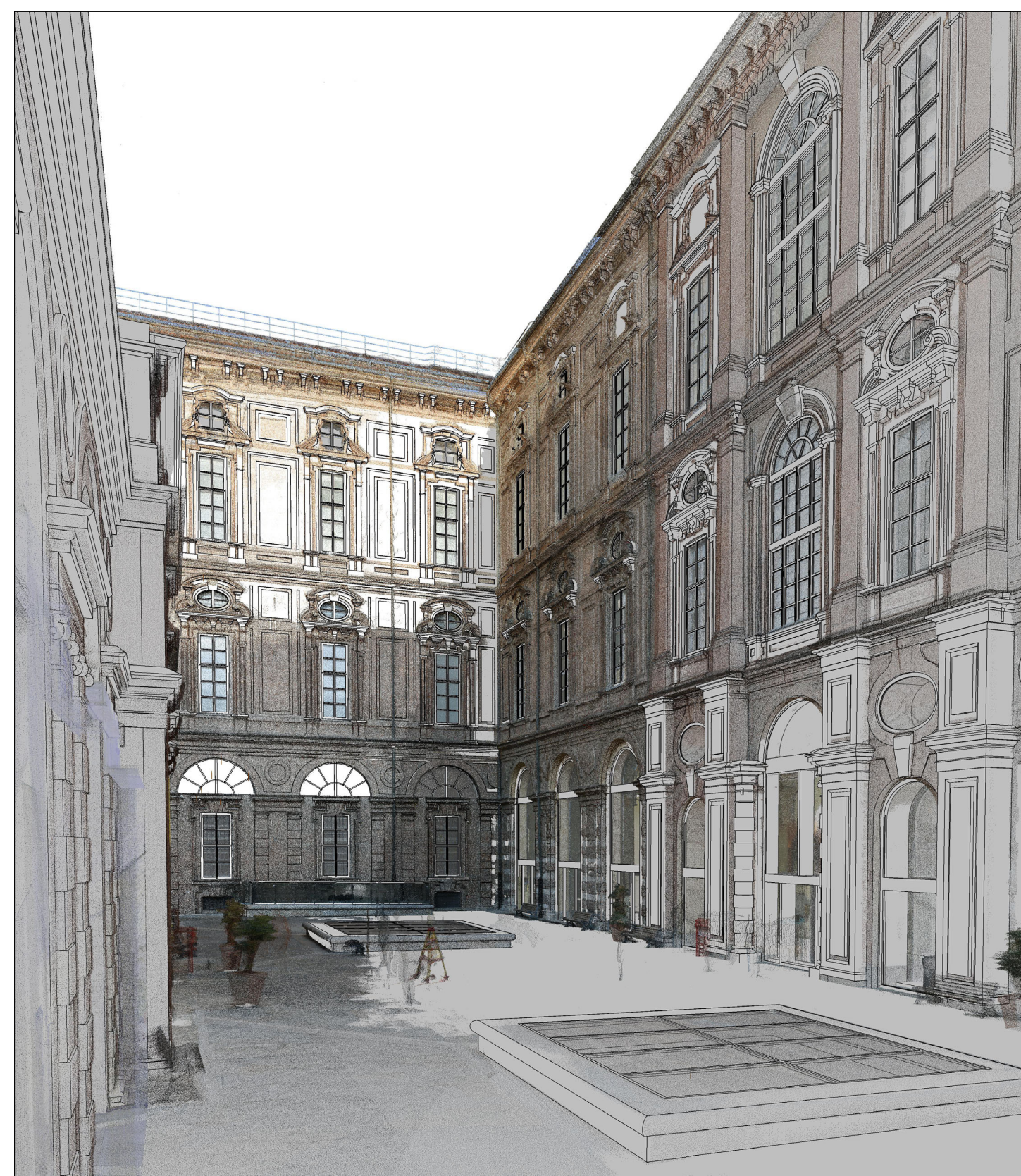
Vista cortile interno: confronto tra modello ibrido (nuvola di punti + modello BIM) e modello concettuale parametrico
