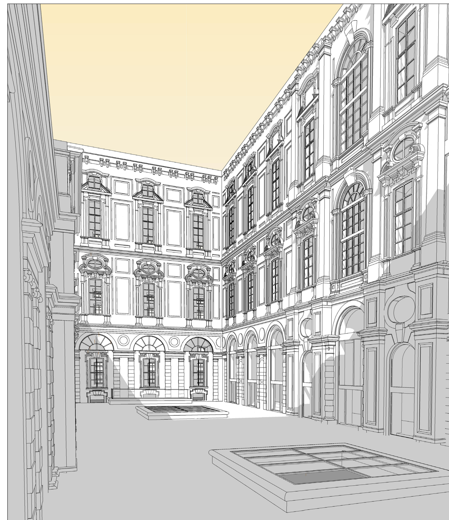
Vista cortile interno: confronto tra modello ibrido (nuvola di punti + modello BIM) e modello concettuale parametrico
