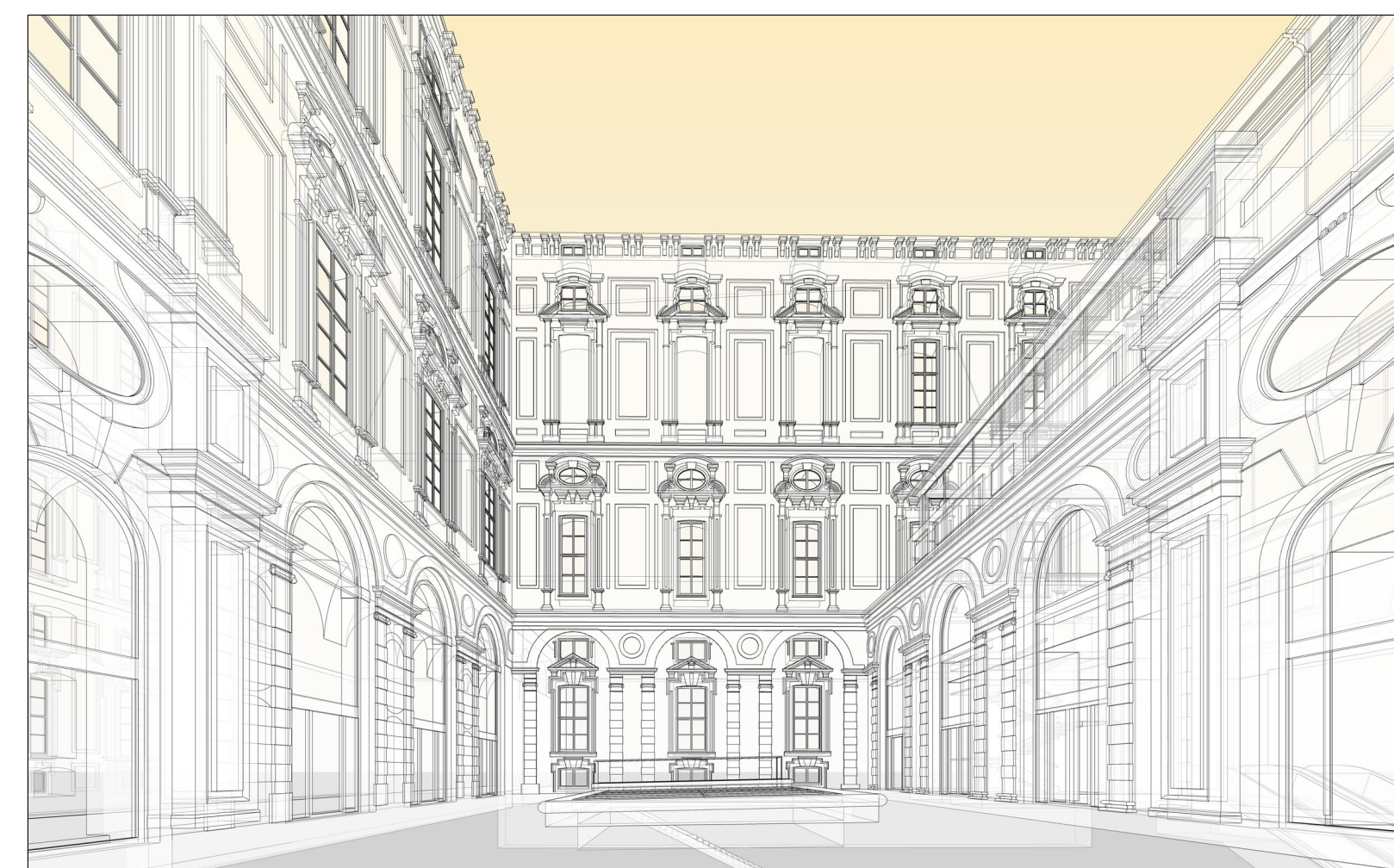
Vista cortile interno: confronto tra nuvola di punti e modello BIM
